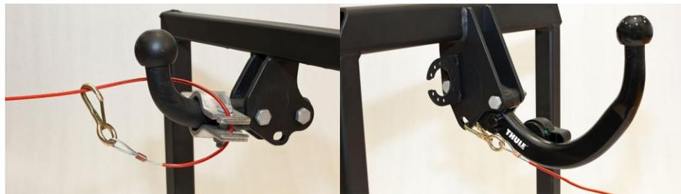
Das Abreißseil darf nicht nur um die Anhängerkupplung geschlagen werden. Das Abreißseil muss befestigt werden, beispielsweise an die Hilfskupplung (1), an einem Loch in der Anhängerkupplung (2) oder am Fahrzeug selbst:
